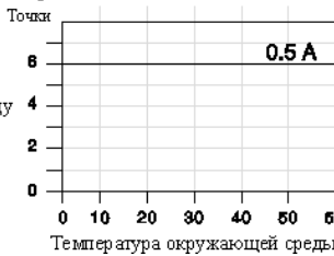
График снижения номинальных характеристик в зависимости от температуры для выходов переменного тока
