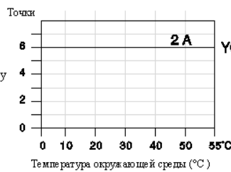
График снижения номинальных характеристик в зависимости от температуры для релейных выходов
