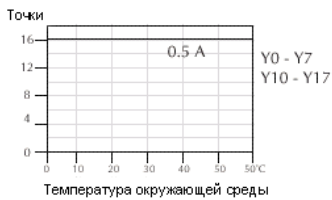
График снижения номинальных характеристик в зависимости от температуры для выходов переменного тока
