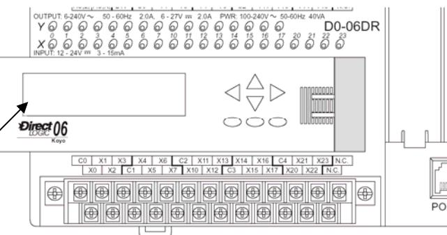
Сдвиньте панель вправо, так чтобы левая сторона панели совпадала с левой стороной контроллера. Фиксатор панели щелкнет при блокировке панели на месте установки.
