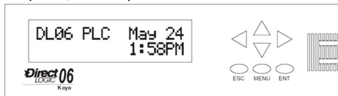
Потенциальные возможности использования LCD-панели для DL06 очень широки. Оператор может изменять значения для введения данных настроек или выбора времени работы механизма для производства различных изделий. Обслуживающий персонал может использовать интерфейс в шкафу управления, чтобы идентифицировать ошибки в работе механизма. Сообщения на LCD-панели могут быть запрограммированы для различных аварий или событий. LCD-панель может удовлетворять и многие другие потребности интерфейса оператора.
