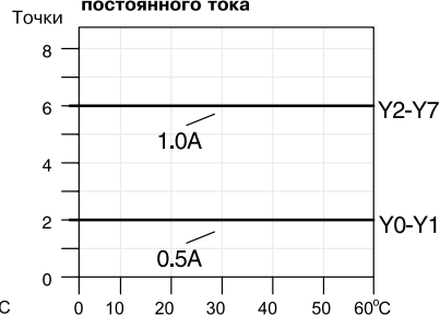
График снижения номинальных характеристик в зависимости от температуры для выходов постоянного тока
