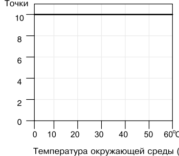
График снижения номинальных характеристик в зависимости от температуры для входов постоянного тока
