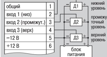
Схема подключения активных датчиков D1...D3 при питании их от внешнего источника
