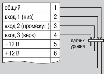
Схема подключения кондуктометрических датчиков уровня
