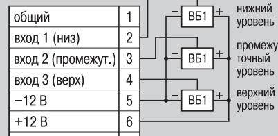
Схема подключения емкостных переключателей
