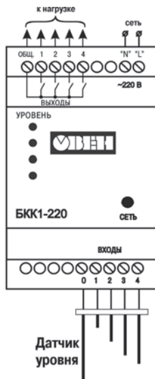
Рис. А.2. Схема подключения БКК1-220
